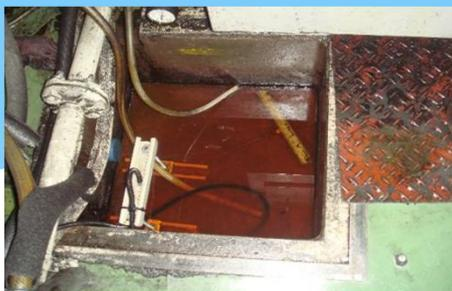
印刷機冷却タンク浮き油
